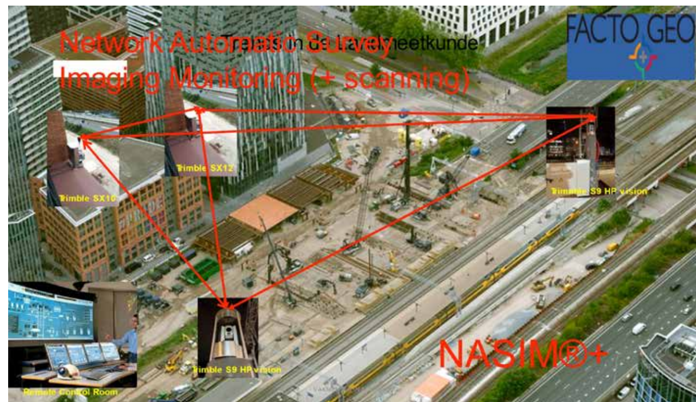
Facto NASIM is een zelf controlerend geometrisch referentienetwerk en ondersteunt realtime het intensieve binnenstedelijk bouwproces 24/7.
